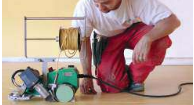
UNIFLOOR E с приспособлением для монтажа катушки со шнуром
