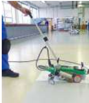
Постоянное качество сварки внахлест без образования складок
