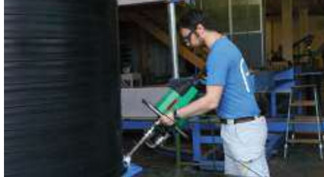
С помощью практичной рукоятки ручной экструдер WELDPLAST S6 легко направляется
