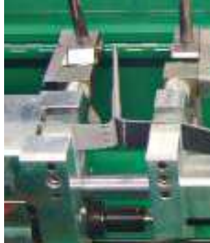
Испытание сварного шва при помощи EXAMO USB
