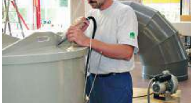
Вентилятор ROBUST подаёт воздух к WELDING PEN
