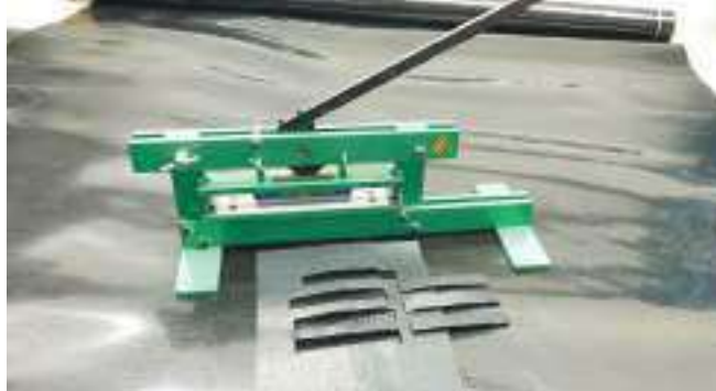
Тестируемые образцы одного размера, быстро изготовленные с помощью лезвия для нарезки
