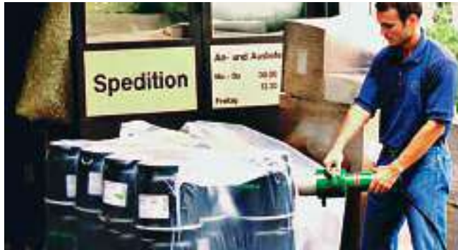
Усадка термоусадочной плёнки на паллетах без использования открытого пламени в закрытых помещениях
