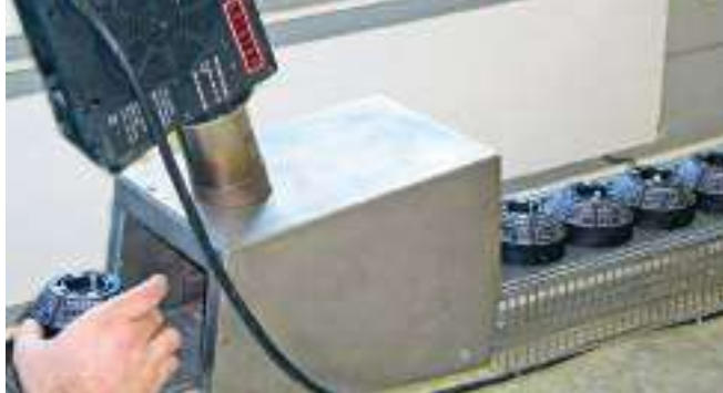
Новый HOTWIND легко интегрируется в систему нагрева на производственной линии
