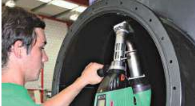
Легко сваривает даже внутри труб
