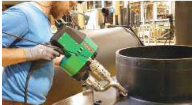
Мощный WELDPLAST S4 в работе
