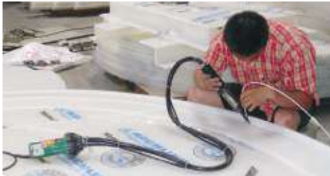
Вентилятор MINOR для подачи воздуха вместе с DIODE PID
