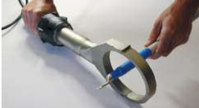
Процесс термоусадки при помощи аппарата ELECTRON ST
