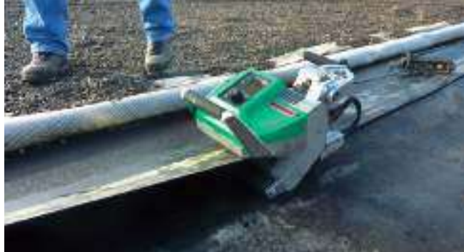
GEOSTAR без проблем сварил около 240 метров шва за один проход во время полевых испытаний (в Южной Африке)
