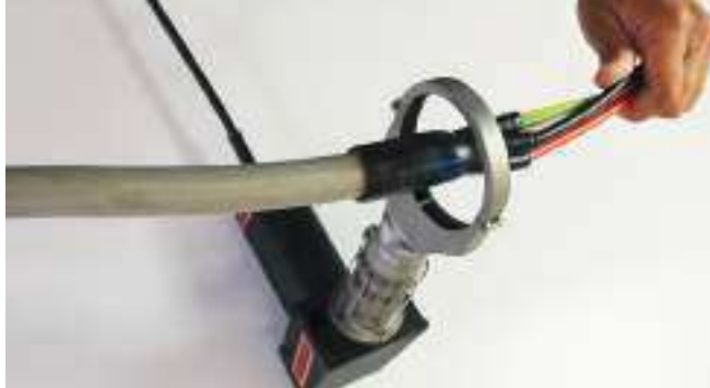
Термоусадка с помощью аппарата GIBLI
